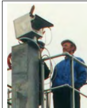
Сканер в защитном кожухе, установленный на башне
