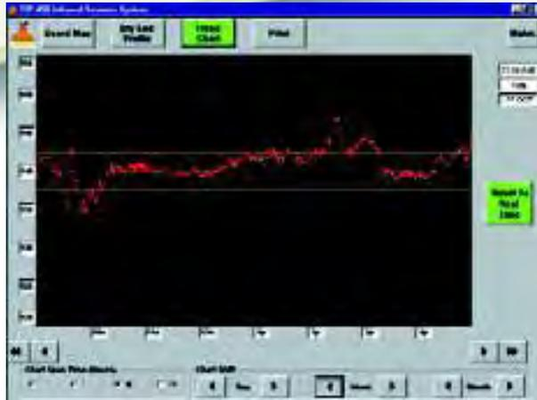
**ДО:** Термопрофиль сушильной печи, через которую пропускается 12 мм лист штукатурки, - до того как работа печи была настроена с помощью системы TIR450. На этом экране ясно видно, что верхний ярус сушится сильнее (светлее), в то время как на других ярусах остаются влажные слои (темнее).
